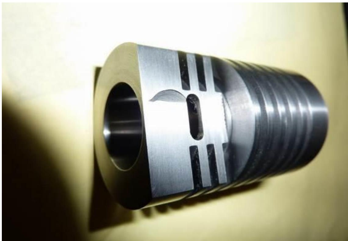
**Slika P.6.19.** Prikaz završnog urezivanja ulaznog otvora
