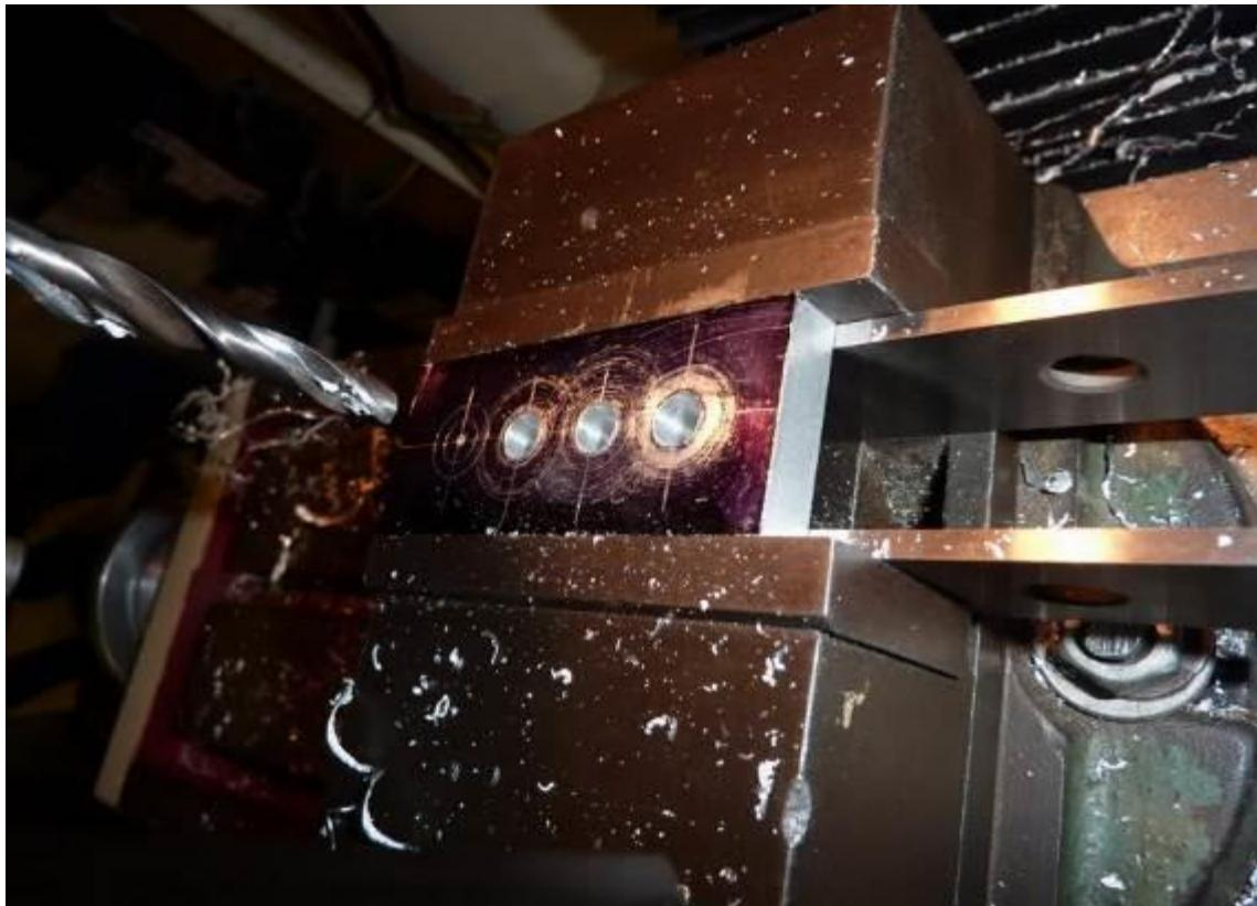
**Slika P.6.52.** Bušenje pod pravim kutom, paziti da je sve dobro učvršćeno
