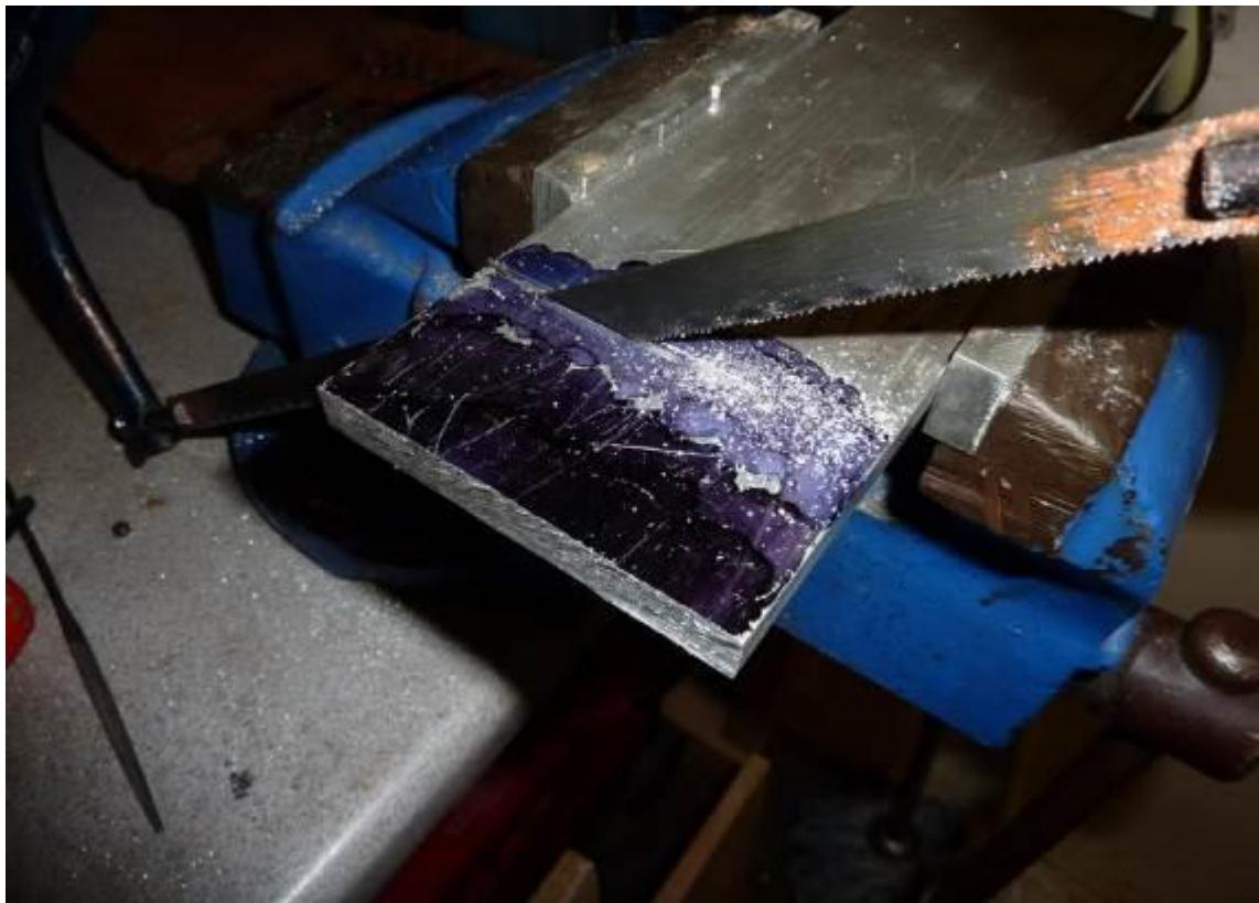
**Slika P.6.82.** Rezanje viška dijela podloge
