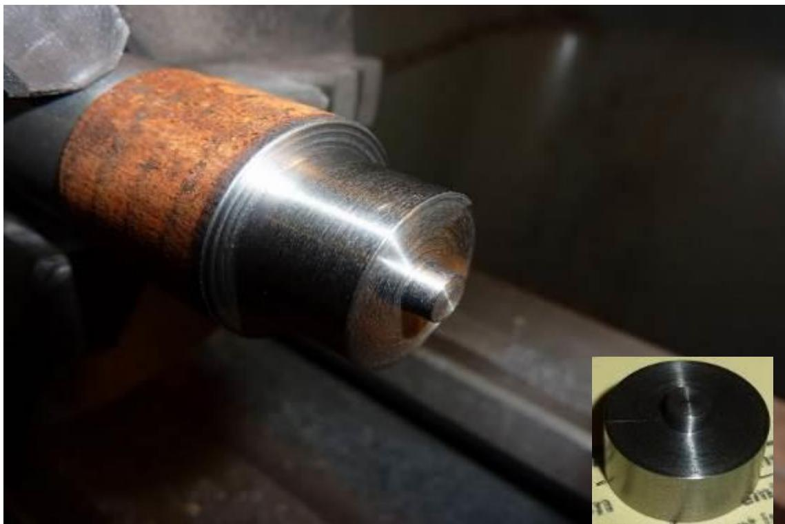
**Slika P.6.30.** Pravljenje čepa i odrezivanje na zadaru mjeru
