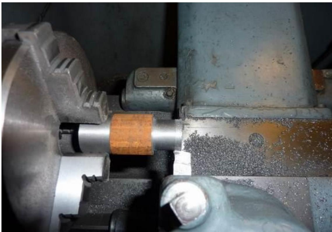
**Slika P.6.29.** Završno skidanje na određenu mjeru (mora biti veće od 0,003 mm)
