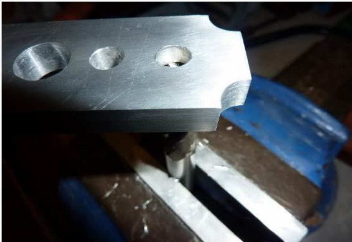
**Slika P.6.58.** Napraviti završnu obradu i ispolirati držač; staviti ležaj radi provjere
