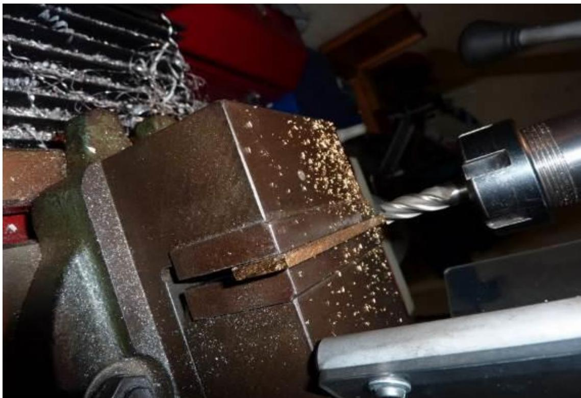
**Slika P.6.78.** Obrada klipnjače u postupku
