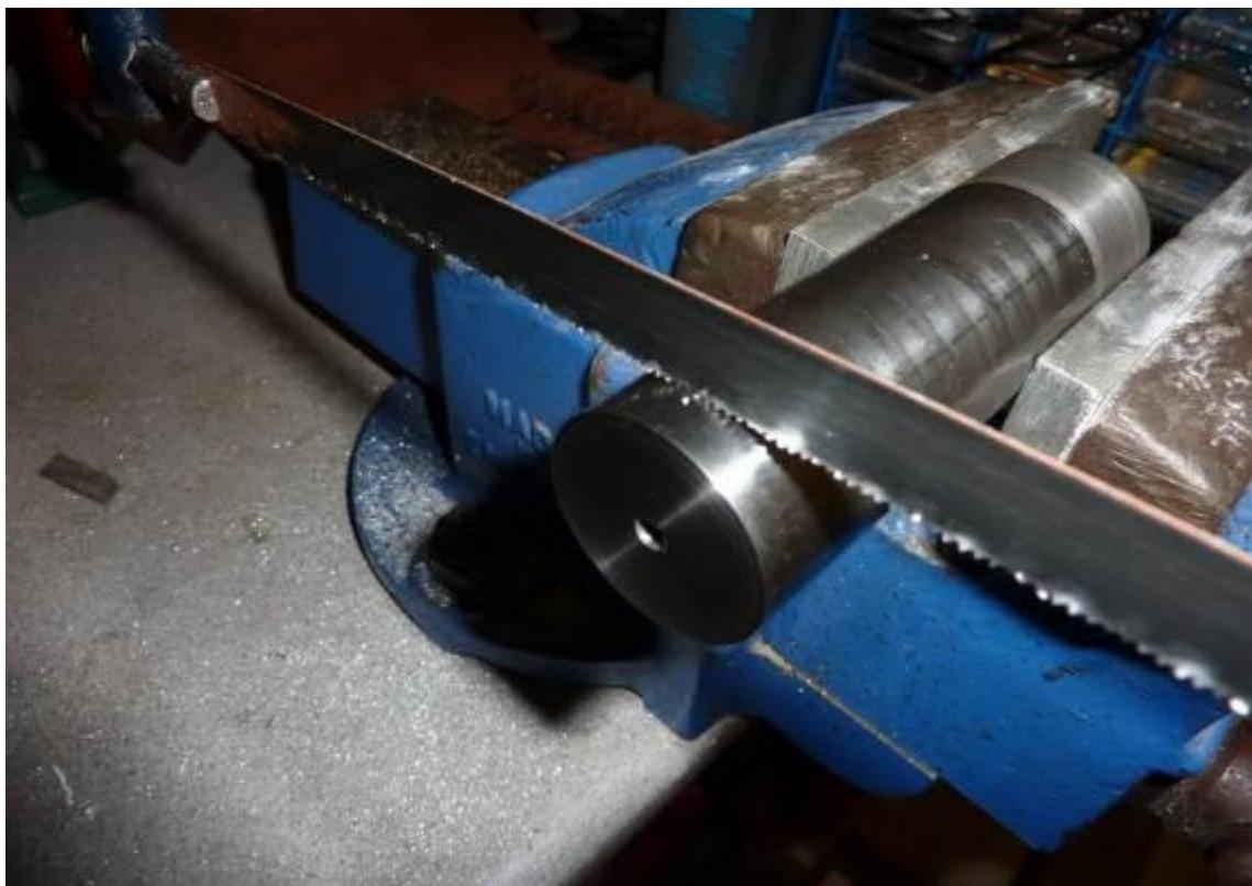
**Slika P.6.60.** Odrezati radilicu prema zadanoj mjeri
