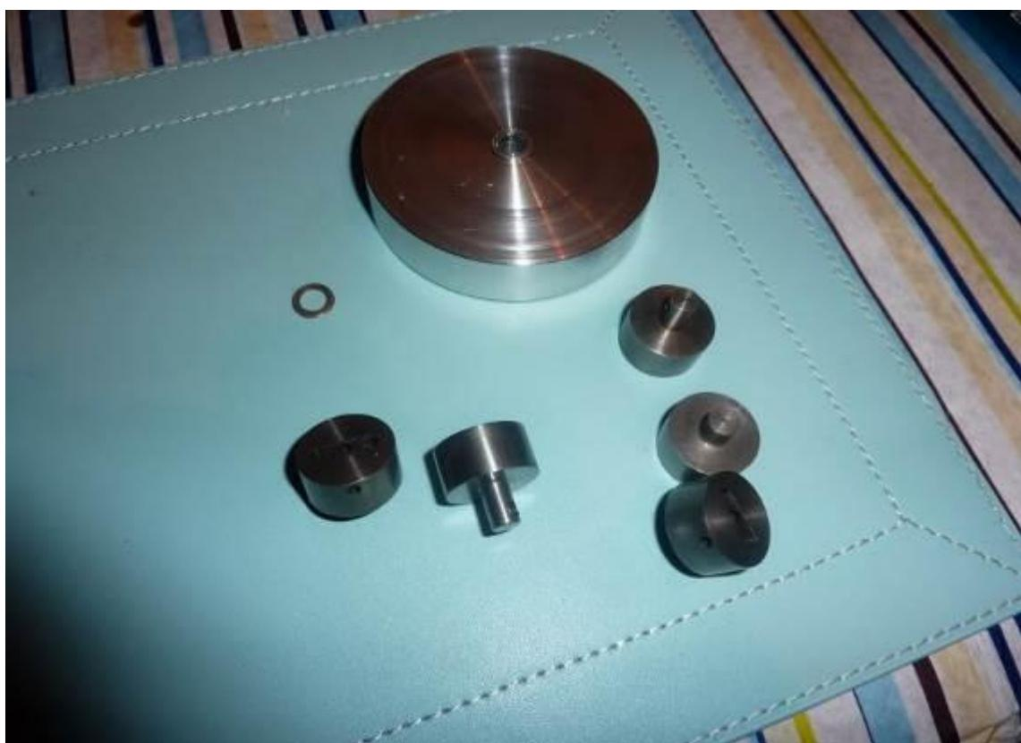
**Slika P.6.89.** Prikazani klipovi koji nisu dobre izrade, odnosno nisu dobre preciznosti
