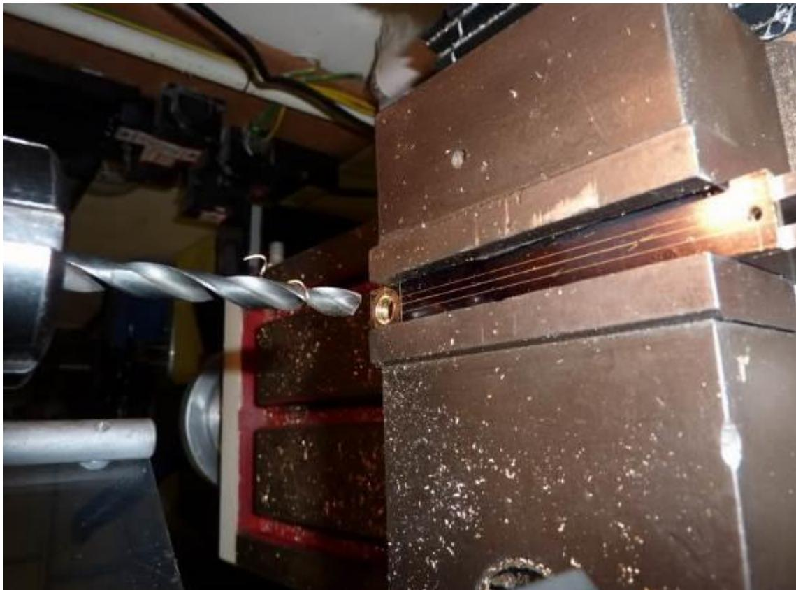
**Slika P.6.80.** Nakon označivanja zadanog odgovarajućim svrdlom i napraviti rupe
