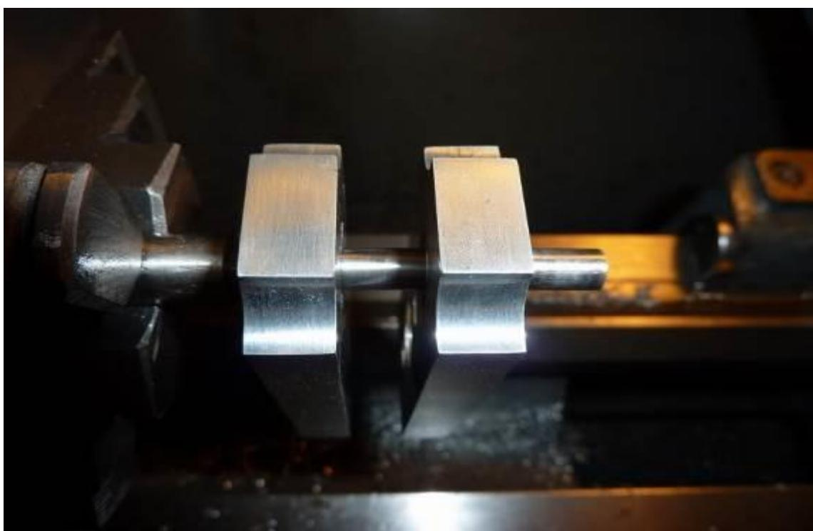
**Slika P.6.63.** Nakon obrade osovine isprobati odgovara li ona držaćima zajedno sa ležajevima u njima
