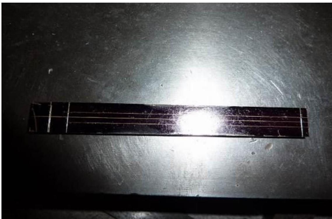
**Slika P.6.79.** Označiti i zabilježiti sve potrebno za daljnju obradu klipnjače po mjerama
