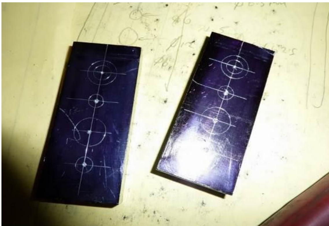
**Slika P.6.51.** Bojanje i označavanje držača na zadane mjere
