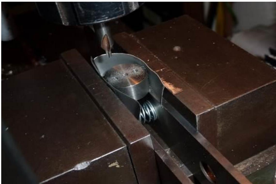
**Slika P.6.72.** Priprema za obradu glavnog radnog, to jest obrtnog klipa
