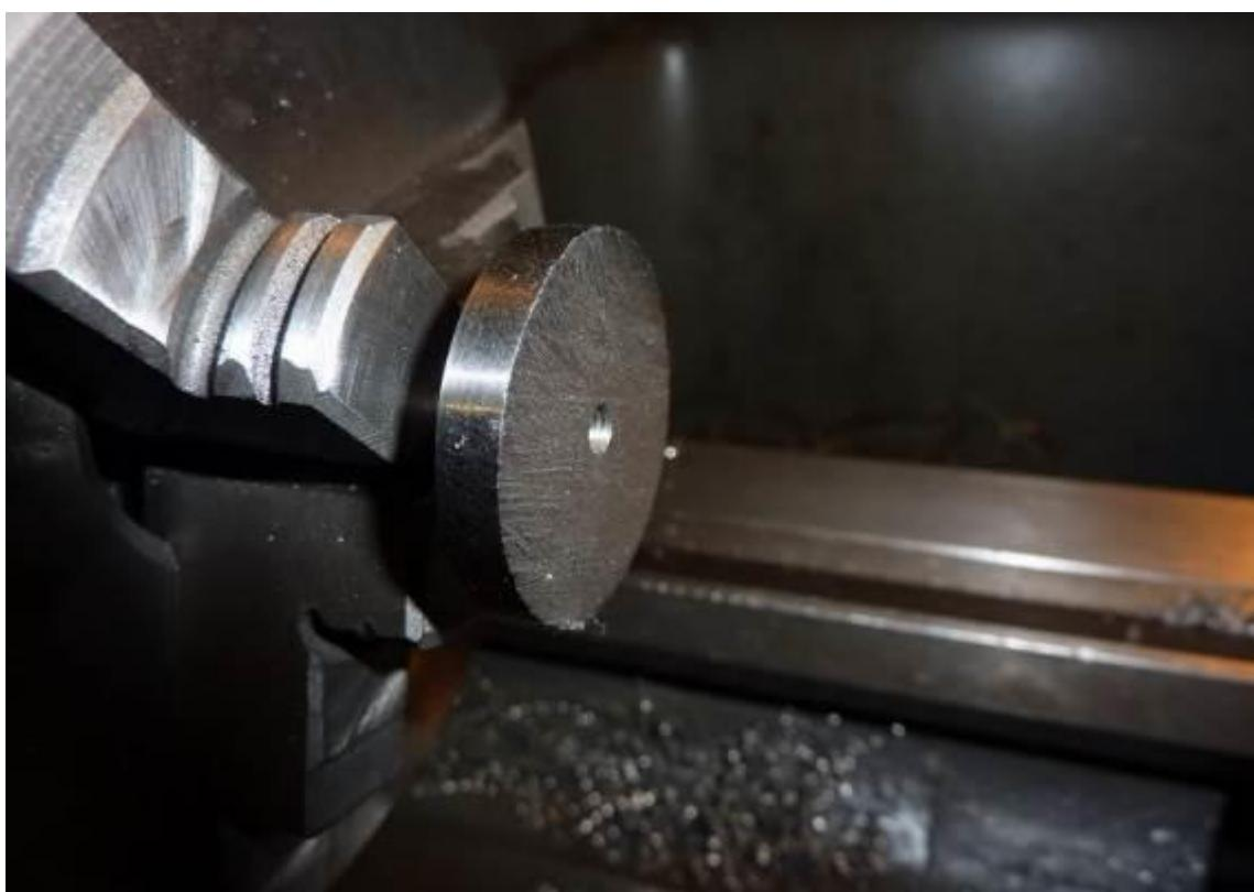
**Slika P.6.65.** Spojiti disk i osovinu preko napravljenog navoja radi provjere ispravnosti navoja
