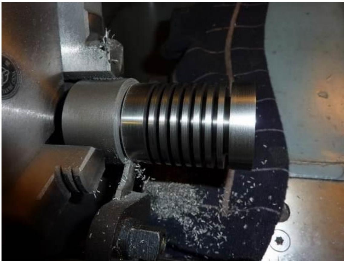
**Slika P.6.12.** Prilikom odrezivanja lagano pridržavati cilindar
