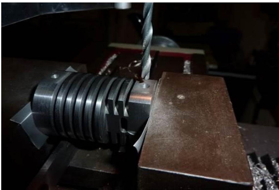
**Slika P.6.23.** Bušenje rupe prema određenoj mjeri
