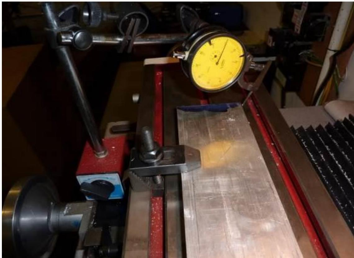
**Slika P.6.84.** Premjeravanje podloge te priprema za njeno rezanje
