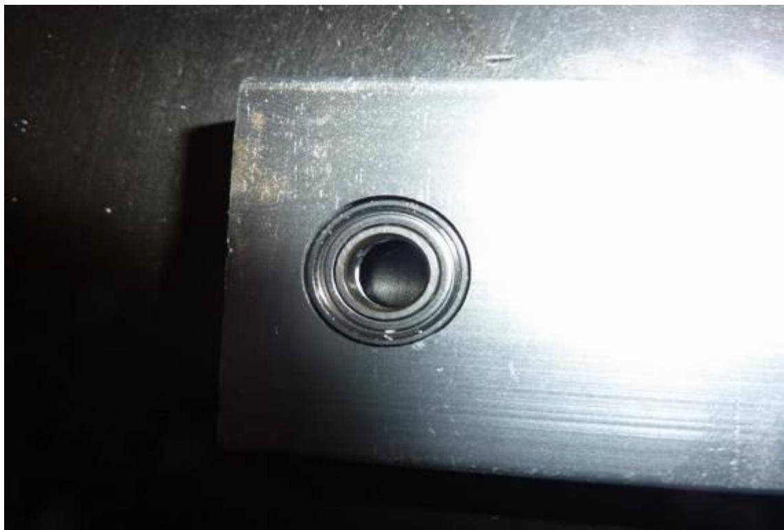
**Slika P.6.43.** Rupa mora biti veće dimenzije, nego što je dimenzija ležaja
