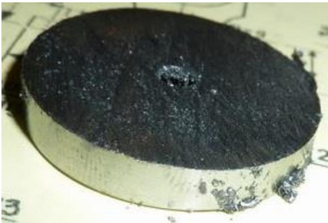
**Slika P.6.61.** Dobiveni oblik nakon rezanja; skinuti strugotinu i ispolirati
