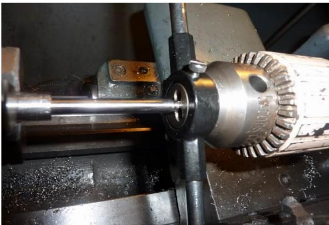
**Slika P.6.64.** Odgovarajućom nareznicom napravite navoj na osovini prema radilici
