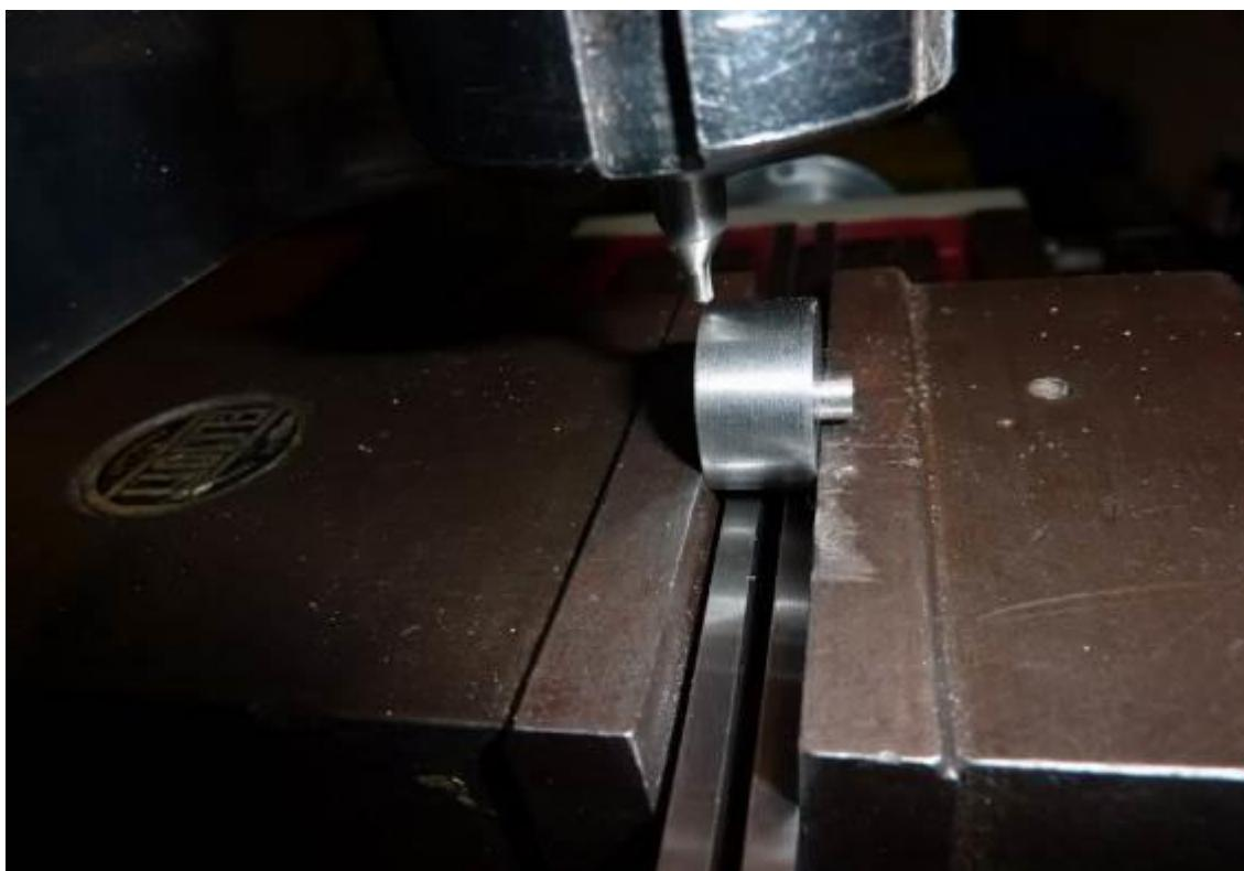
**Slika P.6.75.** Izvesti podešavanje stroja preciznim i ravnim bušenjem
