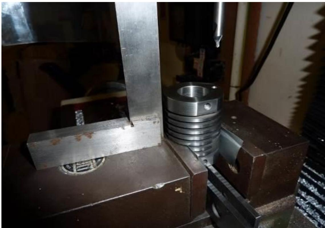
**Slika P.6.25.** Postavljanje centara bušilice za bušenje prikazane rupe
